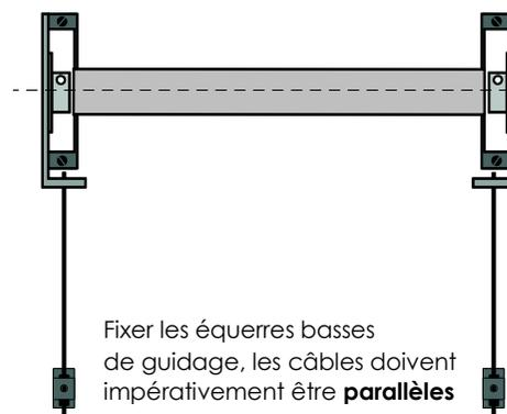
Fixer les équerres basses de guidage, les câbles doivent impérativement être **parallèles**
