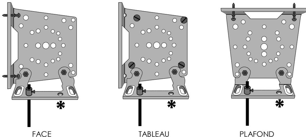
\* Emplacement du guidage en enroulement extérieur
