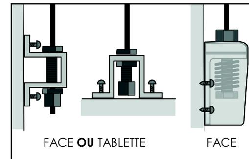
Tendre les guidages à l'aide des tendeurs en partie basse des stores
