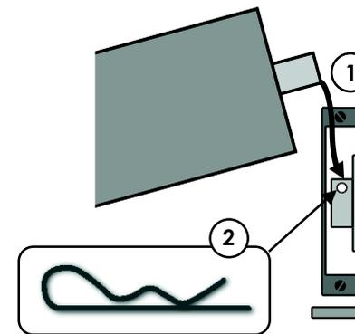
1 - Clipser le tube d'enroulement avec toile dans les équerres
