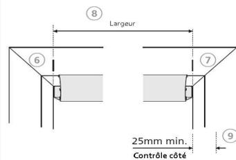
6 Mesurer la dimension du clair de vitrage en largeur (dimension du vitrage sans les joints) pour ce faire, utiliser un petit échantillon du boîtier Intu, placé en butée contre le joint coté gauche de la fenêtre, marquer la position sur le cadre
