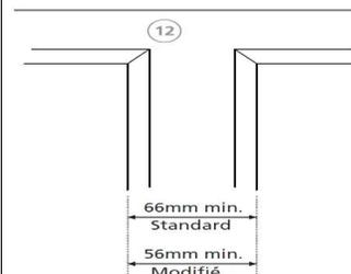
12 Lorsque deux fenêtres sont positionnées côte à côte, ou si le profil de recouvrement est particulièrement étroit, un boîtier raccourci est disponible en option
