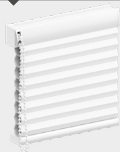
M3 Manœuvre chaînette Bloc manœuvre détachable pour la sécurité enfant. Profil haut : lg. 29 mm x ht. 34 mm. Lg. mini 500 mm. Ht. mini 500 mm. Surface maxi 6 m 2 ou 7 m 2 selon toiles.
