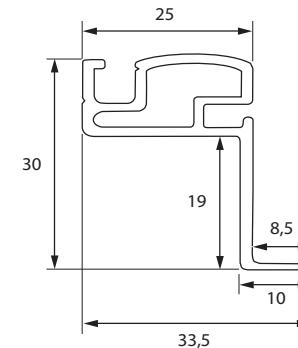
Vérifier la hauteur disponible du dormant mini 10 mm et le déport du jet d'eau 19 mm maximum.
