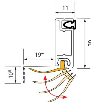
\* Vérifier la hauteur disponible du dormant mini 10 mm et le déport du jet d'eau 19 mm maximum
