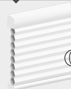
M14 Motorisation autonome PowerView® (Génération 3) Avec batterie Li-Ion rechargeable externe lg 310 mm (blanc, gris ou noir). Si installation à l'arrière du boîtier, prévoir des équerres de déport en pose de face. Profil haut : lg. 29 mm x ht. 34 mm. Lg. mini 450 mm. Surface maxi 7 m 2 .
