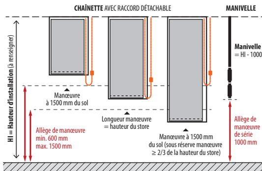
Si la hauteur d'installation est inconnue, la hauteur de manœuvre sera de  $2/3$  de la hauteur du store.
