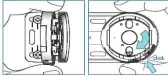
Placez le niveleur sur le support à l'opposé du mécanisme. Assurez vous que l'ouverture pour le passage de la clé Allen soit positionné vers le bas. Tournez le niveleur jusqu'à l'encliquetage.
