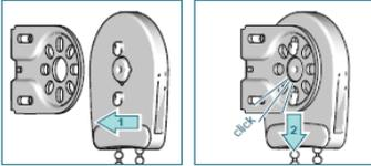
Positionnez le treuil chaînette sur le support et glissez le vers le bas jusqu'à l'encliquetage.
