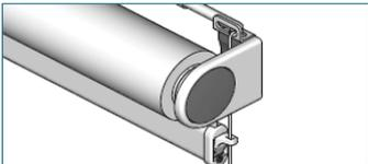
Installez le store. Passez les câbles à travers les embouts de la barre de charge.
