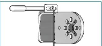
Placez les câbles de guidage au travers des supports de guidage par le trou oblong. La partie avant des tendeurs se positionne dans le trou.
