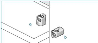
Fixez les supports de guidage : en pose de face (b) ou sur la tablette (a).
