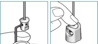
Glissez les câbles dans les inserts et fixez les avec une clé Allen. Mettez l'insert dans le support et presser vers le bas.
