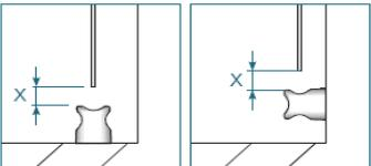
Fixez les supports à la verticale et dans l'axe des câbles. Raccourcir les câbles sans les tendre à une longueur telle qu'ils s'arrêtent à 5 mm des supports
